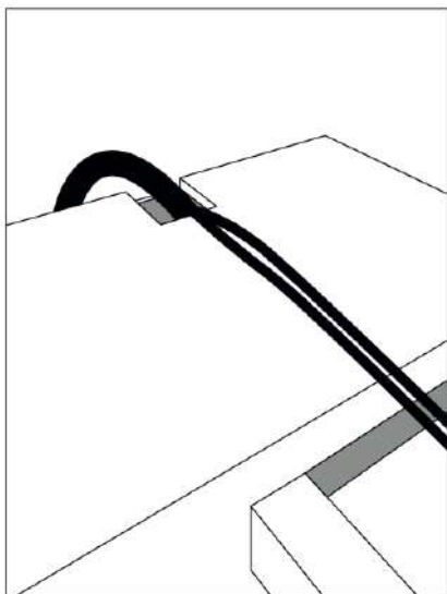
Fig. 19 - Föring av ledningar och oljeslangar genom hålet i topplattan
